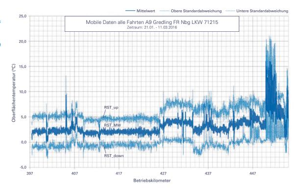
Projektziel ist hier vor allem eine deskriptive Datenanalyse, um passende Einflussfaktoren auf die streckenbezogene Glättevorhersage zu erkennen. Hierzu werden Temperaturdaten der Fahrbahn aus den Winterdienstfahrzeugen an die KI übersandt. Um die Komplexität der Wechselwirkungen berücksichtigen zu können, soll ein hybrides Modell bestehend aus Radial Basis Function (RBF) Kernel, Random Forest und neuro-
