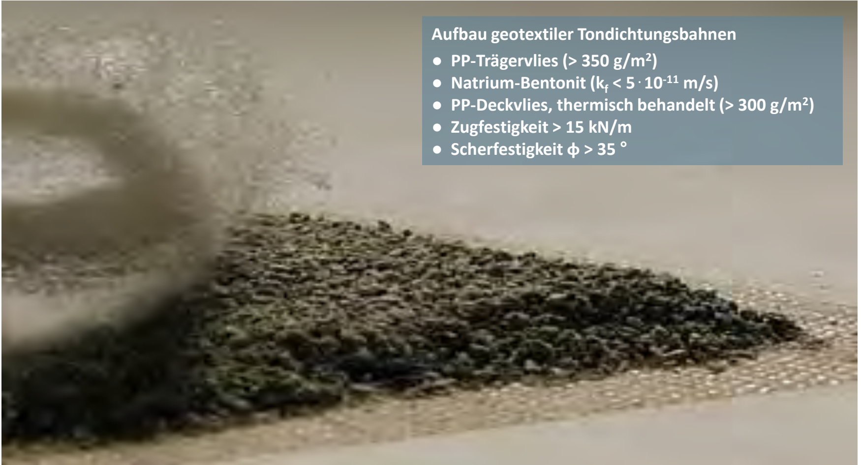
Aufbau einer geotextilen Tondichtungsbahn (gtD)
